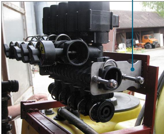
Fertig montierte Steuereinheit MFV
